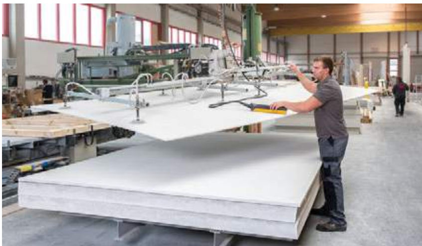
Transport von fermacell® Gipsfaser-Platten mit einem Vakuum-Hebegerät
