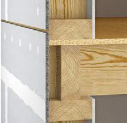
Bild 3: Mit HD-Fugentechnik versehener Bereich des Plattenstreifens
