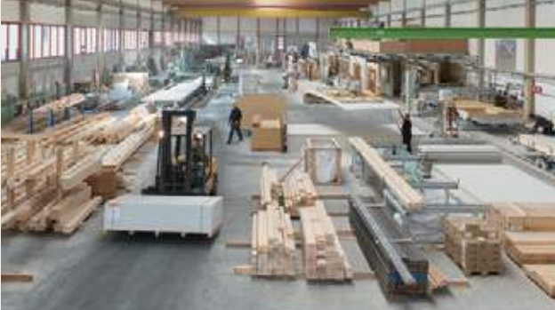
Fertigung von Holzbauelementen mit fermacell® Gipsfaser-Platten
