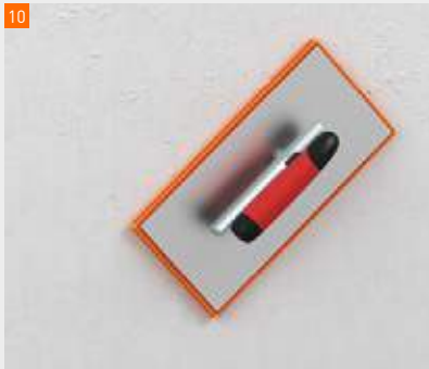
Abfilzen der Putzoberfläche mit einer Schwamm-scheibe
