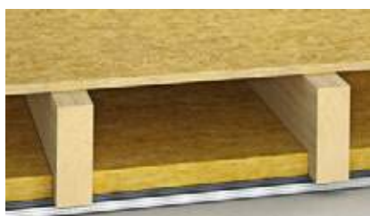
Trockenestrich-Aufbauten zum Erreichen L'_{n,w} = 50 dB
