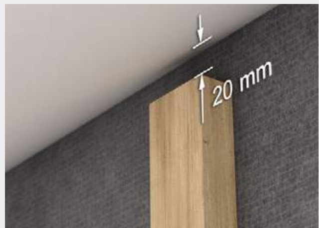
Mindestabstand zwischen Oberkante Traglattung und oberem Abschluss.
