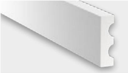
HardieTrim™ NT3™ Zierleisten können einfach mittels Nagelschussgerät angebracht werden, ein Vorbohren ist nicht erforderlich. Eine richtig eingestellte Eintreibtiefe verhindert die Beschädigung des Produktes. Für die Befestigung von HardieTrim™ NT3™ Zierleisten auf der Unterkonstruktion müssen die Nägel mindestens 22 mm in die Unterkonstruktion eindringen. Die Nägel werden bündig oder max. 1 mm versenkt eingetrieben, so dass die Nagelköpfe farblich beschichtet werden können.
