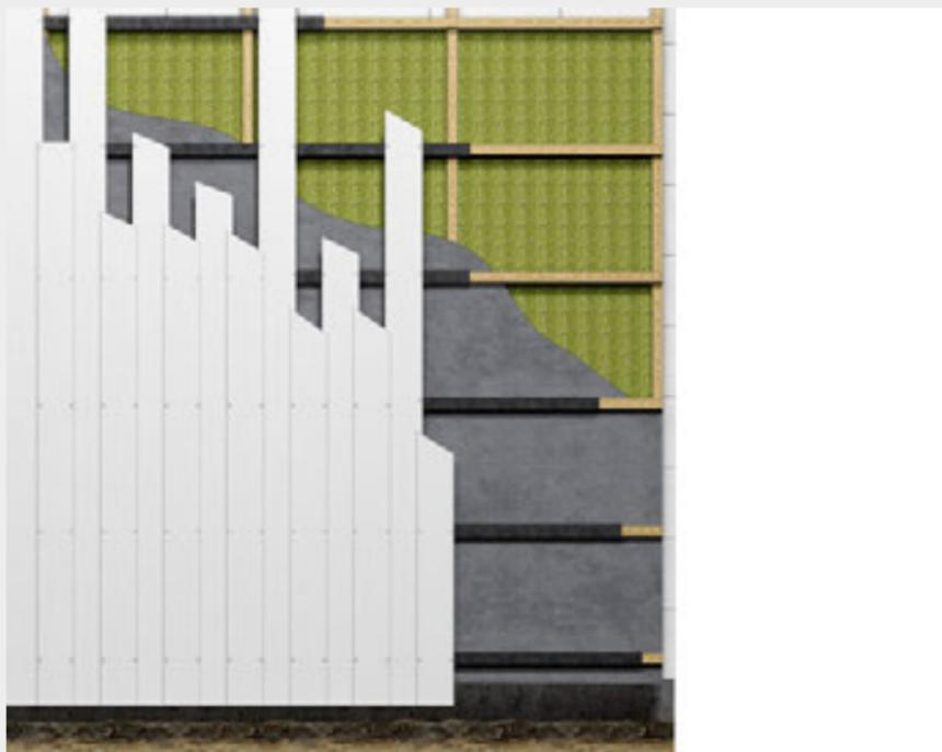
Anordnung der Boden-Deckel-Schalung.
