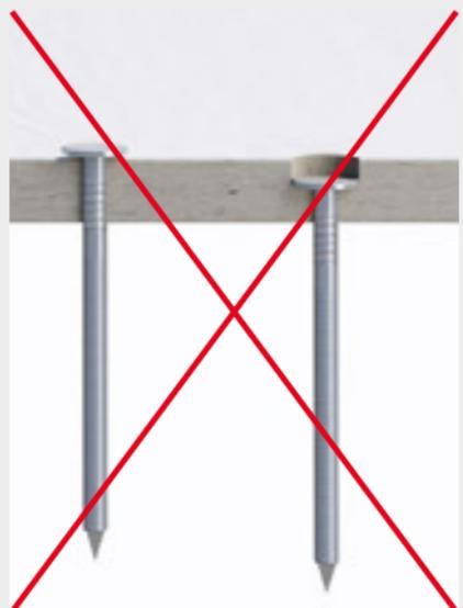
Für die Befestigung über Eck empfiehlt sich der Einsatz von Stauchkopfnägeln (Stiftnägeln), die einen Durchmesser von 1,6 mm aufweisen sollten. Alternativ kann nach erfolgtem Vorbohren die oben beschriebene Edelstahlschraube 3,5 x 50 mm verwendet werden.
