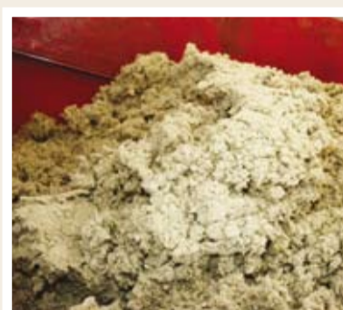
Rund 30 m 3 Granulat HR der Deutschen Rockwool wurden in die Außenwände des Monschauer Holzhauses eingeblassen. Dieses jüngste Mitglied der Rockwool Einblas-Granulate verfügt über eine allgemeine bauaufsichtliche Zulassung als Dämmstoff der Baustoffklasse A1 nichtbrennbar nach DIN 4102-1 für den Einsatz im Holzbau.
