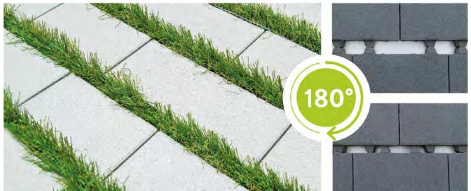
Eine Drehung, zwei Möglichkeiten: Durch Drehen des Greenline-Steins um 180 Grad kann zwischen einer Fugenbreite von 2,5 cm und 5,0 cm gewählt werden. Durch die speziell ausgeformten Abstandhalter des Greenline-Steins kommt es zu einer Verzahnung zwischen den Steinen, um eine höhere Flächenstabilität zu gewährleisten.
